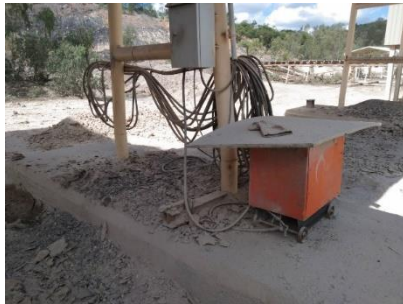
ตู้เชื่อมไฟฟ้ามีการใช้สายที่ผิดประเภทและมีหลายจุดที่ไม่ผ่านมาตรฐาน
